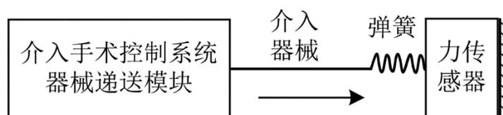
图8 力检测测量方法示意图
