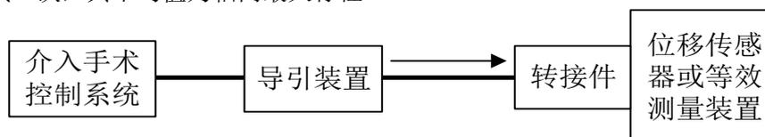
图2 轴向最大行程测量方法示意图
