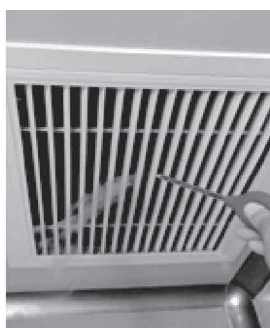
图4 B2型生物安全柜运行时回风倒流
