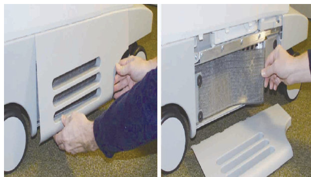
图 1 拆开设备主电源下端的散热网格
