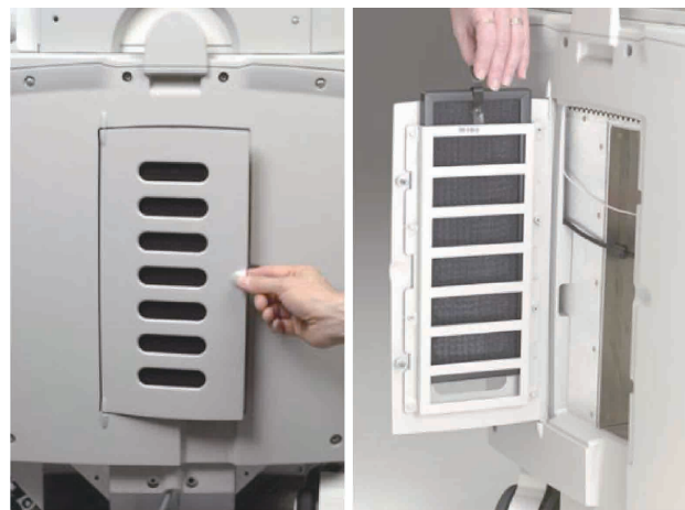
图 2 清理后端 PC 散热防尘网格
